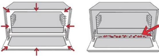
**Чистка:** Осуществлять чистку всегда утром, когда печь не горячая! Очень важно содержать в чистоте раму дверцы по периметру, ее внутреннюю панель и внутреннюю раму печи. Это нужно для того, чтобы дверца хорошо закрывалась в течение дня.
